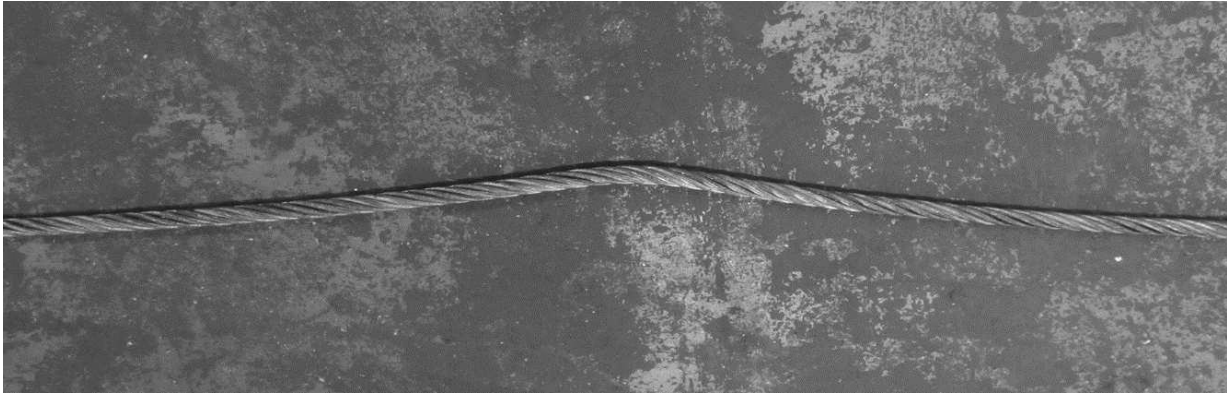
Figura 30-1.8.2-2 Distorsión de la estructura del cable: pata de perro
