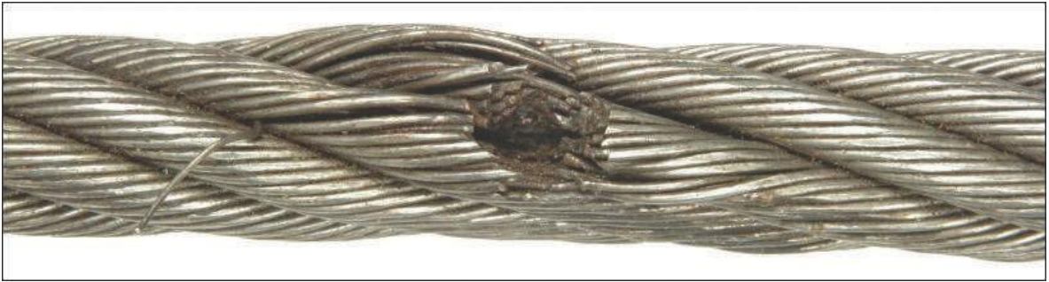
Figura 30-1.8.2-7 Daño causado por el calor
