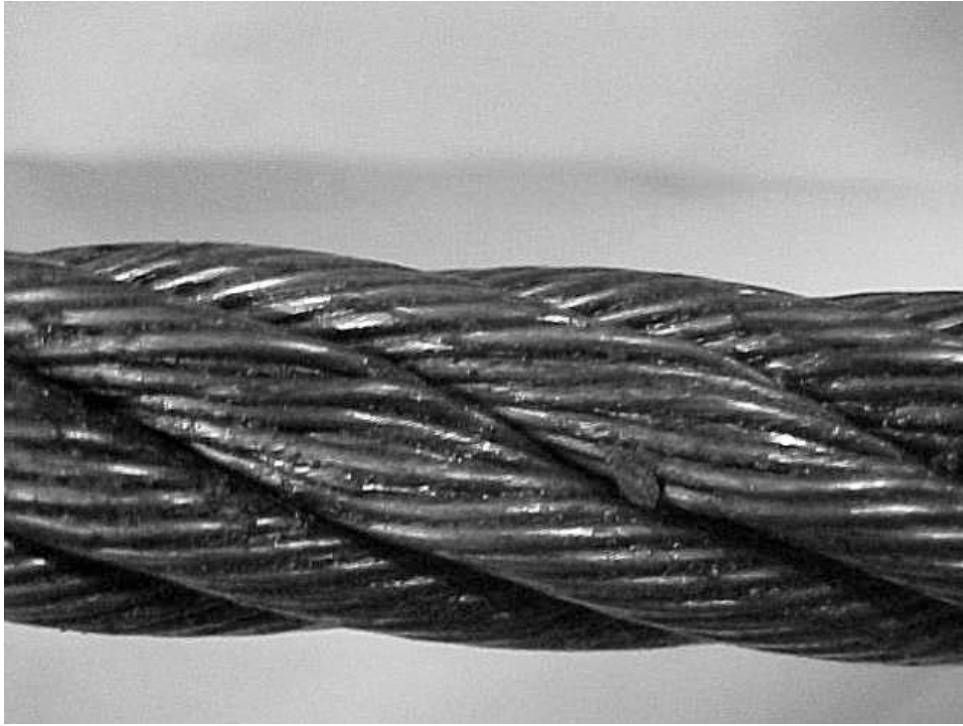
Figura 30-1.8.2-4 Distorsión de la estructura del cable — Aplastamiento
