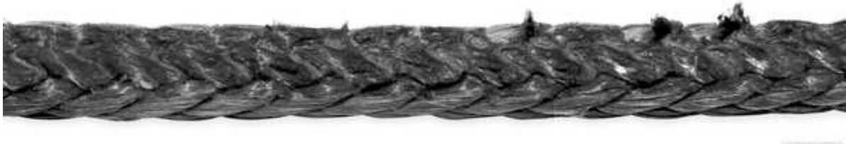
Figura 30-2.8.2-5 Daño por fusión debido al calor
