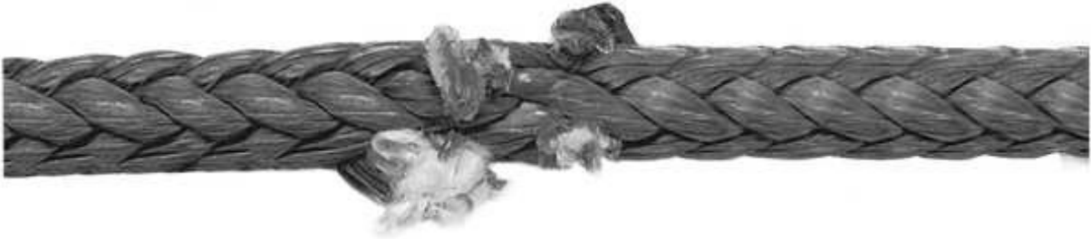
Figura 30-2.8.2-1 Cortes, hendiduras y rotura del material de hilos
